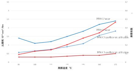
Block on Ring tribometer 試験、1m/s, 5MPa, 乾燥状態、相手材100Cr6
