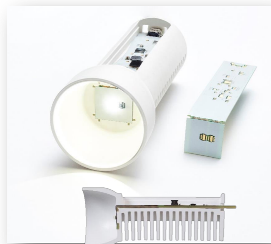
LEDランプのヒートシンク (PETベース、8W/mK品)
