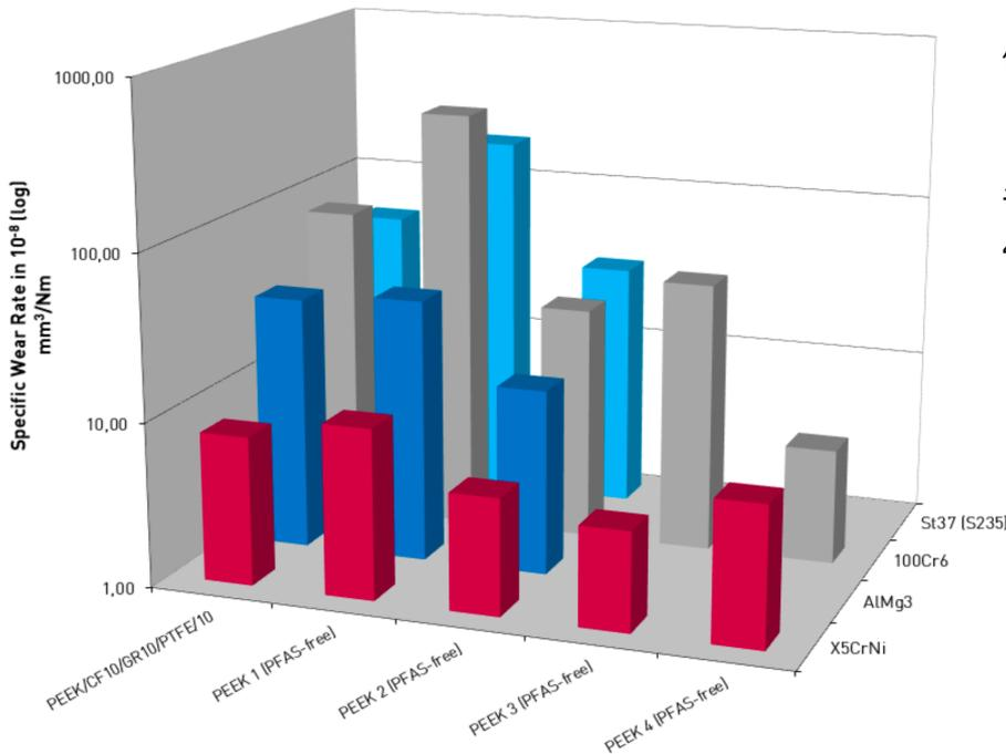
代表的なPEEK摺動性コンパウンド処方 (PEEK/CF10%/黒鉛10%/PTFE10%) とPFASフリー処方4種の比摩耗量 比較データです。4つの異なる相手材と試験をしています。
