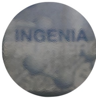
加工助剤なしのフィルムは表面が粗くヘイズが発生
